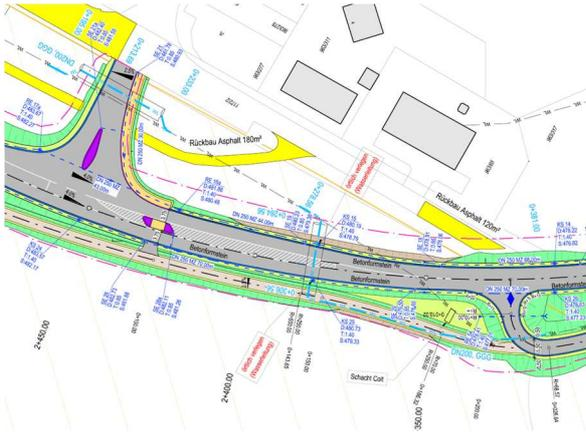
Für die Anbindung der Umgehungsstraße an die Goldkronacher Straße beim bestehenden Gewerbegebiet wurde die Lösung mit einem Kreisverkehr gewählt. Der Kreisverkehrsplatz weist einen Inseldurchmesser von 21m und einen Außendurchmesser von 35m auf. Integriert im östlichen Fahrbahnteiler wurde eine Querungshilfe für die Fußgänger ausgebildet.
