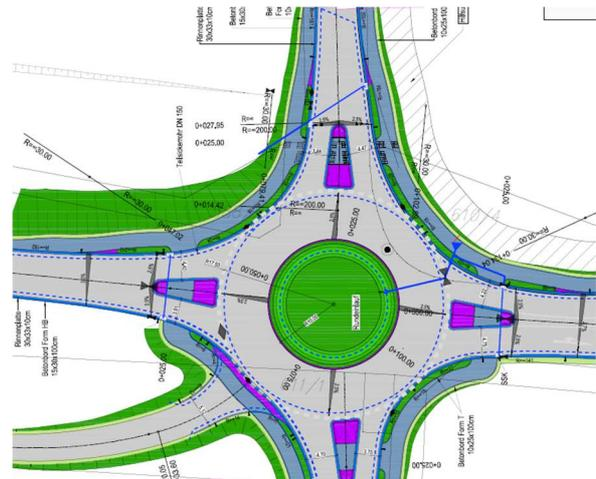
Für die Zufahrt zu den Rückhaltebecken der BAB9 bzw. zur Dienstauffahrt auf die BAB 9 wurde ein fünfter Verkehrsast im südwestlichen Quadranten des KVP hergestellt. Der Gehweg um den KVP wurde in diesem Ast nicht unterbrochen, lediglich der Bord wurde abgesenkt.
